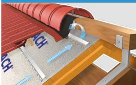
Dettaglio microventilazione colmo
