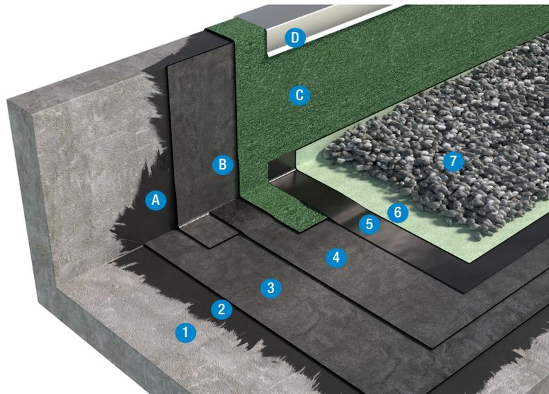
Il raccordo dell'elemento di tenuta sui risvolti verticali di opere complesse o laddove non sia possibile l'uso di fiamme libere, può essere realizzato utilizzando il ciclo poliuretano/bituminoso ALSAN FLASHING marcato CE grazie alla Valutazione Tecnica Europea (ETA-08/0114). Per maggiore approfondimento consultare la documentazione specifica.
