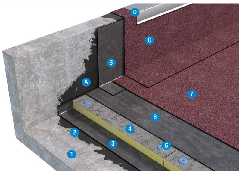
Il raccordo dell'elemento di tenuta sui risvolti verticali di opere complesse o laddove non sia possibile l'uso di fiamme libere, può essere realizzato utilizzando la resina impermeabilizzante poliuretana monocomponente ALSAN FLASHING QUADRO marcata CE grazie alla Valutazione Tecnica Europea (ETA-17/0154). Per maggiore approfondimento consultare la documentazione specifica.
