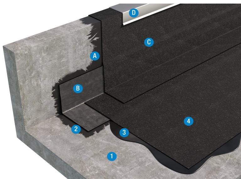
Il raccordo dell'elemento di tenuta sui risvolti verticali di opere complesse o laddove non sia possibile l'uso di fiamme libere, può essere realizzato utilizzando la resina impermeabilizzante poliuretanicca monocomponente **ALSAN FLASHING QUADRO** marcata CE grazie alla Valutazione Tecnica Europea (ETA-17/0154). Per maggiore approfondimento consultare la documentazione specifica.
