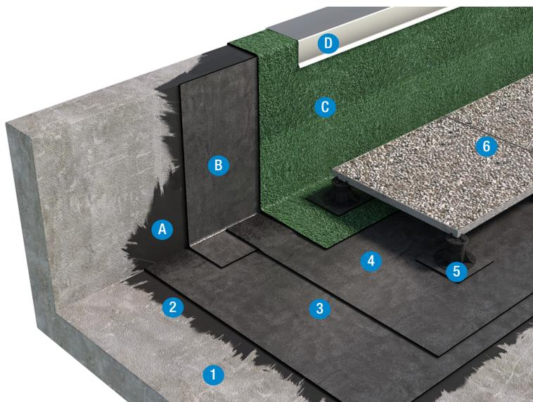
Il raccordo dell'elemento di tenuta sui risvolti verticali di opere complesse o laddove non sia possibile l'uso di fiamme libere, può essere realizzato utilizzando il ciclo poliuretano/bituminoso ALSAN FLASHING marcato CE grazie alla Valutazione Tecnica Europea (ETA-08/0114). Per maggiore approfondimento consultare la documentazione specifica.
