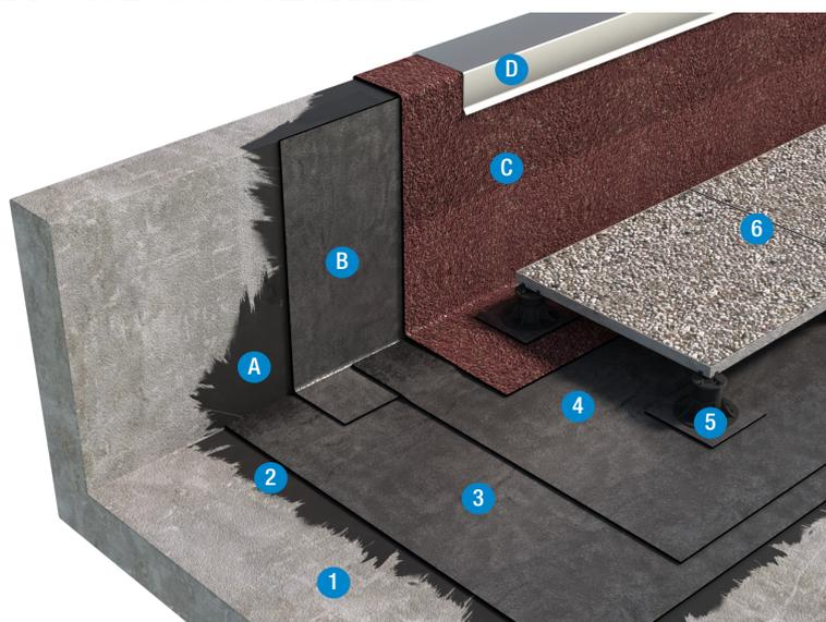
Il raccordo dell'elemento di tenuta sui risvolti verticali di opere complesse o laddove non sia possibile l'uso di fiamme libere, può essere realizzato utilizzando la resina impermeabilizzante poliuretana monocomponente ALSAN FLASHING QUADRO marcata CE grazie alla Valutazione Tecnica Europea (ETA-17/0154). Per maggiore approfondimento consultare la documentazione specifica.
