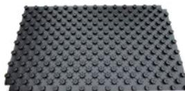
**TECKFLOOR:** Lastra isolante di polistirene espanso EPS stampato, rivestito all'estradosso con film rigido nero con sagomatura portatubo, per la realizzazione di sistemi di riscaldamento a pannelli radianti, conforme alla norma UNI EN 13163.
