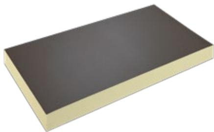
Lastre isolanti di poliuretano espanso, con marcatura CE conformi alla Norma UNI EN 13165, con rivestimento sulla faccia superiore in velovetro bitumato e su quella inferiore con velovetro mineralizzato, **conformi ai Criteri Ambientali Minimi - CAM.**
