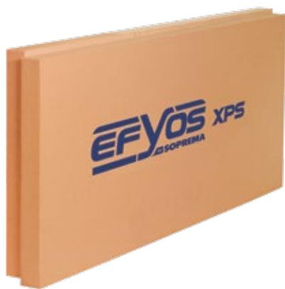
Lastre isolanti di polistirene espanso estruso a celle chiuse, con marcatura CE conformi alla norma UNI EN 13164, con reazione al fuoco in Euroclasse E, conformi ai Criteri Ambientali Minimi - CAM.
