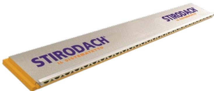
Sistema costituito da una lastra termoisolante di polistirene espanso estruso con rivestimento all'estradosso di una membrana in alluminio goffrato basso-emissivo con inserito un profilo metallico portategola, conforme ai Criteri Ambientali Minimi - CAM.
