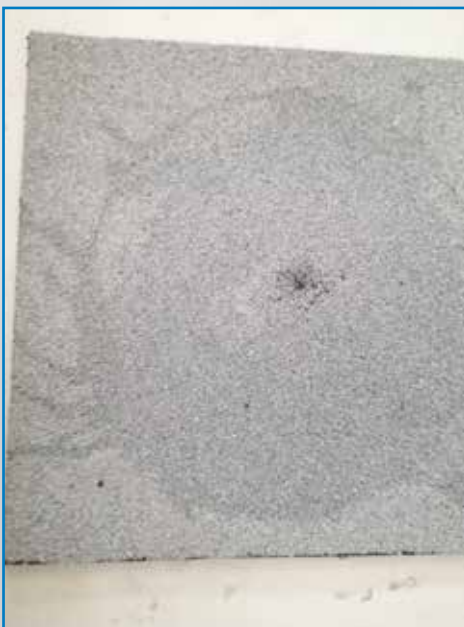
Test per la Determinazione della Resistenza alla Grandine di membrana flessibile secondo la norma UNI EN 13583:2012
