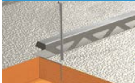
Dettaglio fissaggio meccanico dei pannelli
