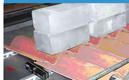
Prova di resistenza del profilo metallico portategole - Rel. Tecnica nr. 4290/RT/06 Fase di carico di schiacciamento e trazione dei profili metallici
