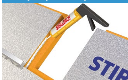
Dettaglio sigillatura dei giunti
