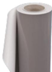
Membrana sintetica realizzata in PVC-P armata con rete di poliestere, dotata di signal layer, prodotta per coostrusione o per spalmatura, resistente ai raggi UV.
