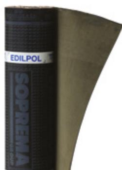
Membrana bituminosa con massa impermeabilizzante classificata BPP (Bitume Polimero Plastomero) secondo norma UNI 8818, costituita da bitume distillato modificato con polimeri poliolefinici (APP) da rinforzo interno composito in geotessile nontessuto di poliestere stabilizzato con fibre di vetro.
