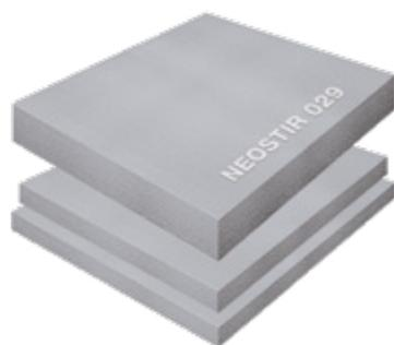
Lastre di polistirene espanso EPS stampato di color grigio additivate con grafite, con marcatura CE conformi alla Norma UNI EN 13163, con Conduttività termica  $\lambda_D = 0,029$  W/mK Norma EN 12667, con Resistenza alla compressione  $\geq 150$  kPa, conformi ai **Criteri Ambientali Minimi - CAM**.
