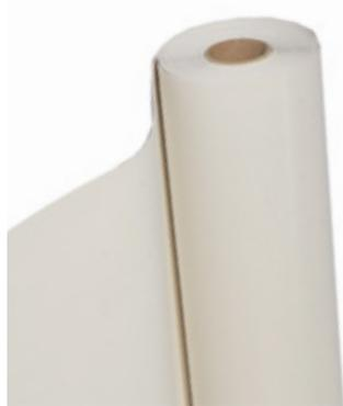
Membrana sintetica realizzata in PVC-P, ottenuta mediante costruzione, resistente ai raggi UV, omogenea, di colorazione bianca. Certificata per il contatto con acqua potabile. Prodotto con marcatura CE conforme alla norma EN 13361, EN 13362. Disponibile su richiesta nella versione speciale di colore grigio scuro (RAL 7037) per l'impermeabilizzazione di vasche per itticoltura
