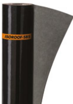
Membrana bituminosa con massa impermeabilizzante classificata BPE (Bitume Polimero Elastomero) secondo norma UNI 8818, costituita da bitume distillato modificato con elastomeri termoplastici (SBS) e da rinforzo interno composito in geotessile nontessuto di poliestere da filo continuo stabilizzato con fibre di vetro. Prodotto con marcatura CE conforme alle norme EN 13707, EN 13969, EN 13970, EN 13859-1.
