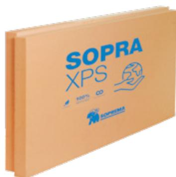
Lastre di polistirene estruso XPS, con marcatura CE conformi alla Norma UNI EN 13164, con Conduttività termica  $\lambda_D = a 0,033$  W/mK Norma EN 12667, Resistenza alla compressione  $\geq 300$  kPa Norma EN 826, Reazione al fuoco in Euroclasse E, con Dichiarazione Ambientale di categoria EPD, conformi ai **Criteri Ambientali Minimi - CAM**.
