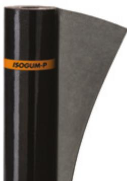
Membrana bituminosa con massa impermeabilizzante classificata BPE (Bitume Polimero Elastomero) secondo norma UNI 8818, costituita da bitume distillato modificato con elastomeri termoplastici (SBS) e da rinforzo interno composito in geotessile nontessuto di poliestere da filo continuo stabilizzato con fibre di vetro. Prodotto con marcatura CE conforme alle norme EN 13707, EN 13969, EN 13970, EN 13859-1. Flessibilità a freddo:  $\leq -20^{\circ}\text{C}$  (EN 1109)
