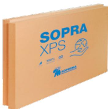
Lastre di polistirene estruso XPS, con marcatura CE conformi alla Norma UNI EN 13164, Resistenza alla compressione  $\geq 300$  kPa Norma EN 826, Reazione al fuoco in Euroclasse E, con Dichiarazione Ambientale di categoria EPD, conformi ai **Criteri Ambientali Minimi - CAM**.
