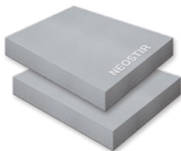
Lastre di polistirene espanso EPS di color grigio additivate con grafite, con marcatura CE conformi alla Norma UNI EN 13163, con Conduttività termica  $\lambda_D = 0,030$  W/mK Norma EN 12667, con Resistenza alla compressione  $\geq 150$  kPa, con Dichiarazione Ambientale EPD di categoria, conformi ai **Criteri Ambientali Minimi - CAM**.
