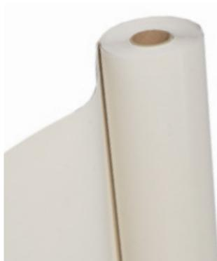
Membrana sintetica realizzata in poliolefina flessibile modificata TPO, di colorazione bianca per tutto lo spessore, con elevato indice di riflettanza solare (SRI). Ottenuta per coestrusione, armata con rete di poliestere, con elevata resistenza ai raggi UV.
