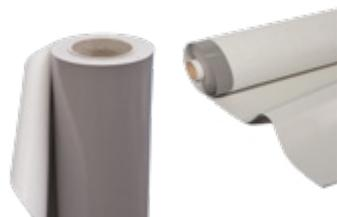
Membrana sintetica realizzata in PVC-P armata con rete di poliestere, dotata di signal layer, prodotta per coestrusione (Flagon SR) o spalmatura (Flagon SR e Flagon SRF), resistente ai raggi UV.
