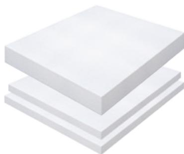
Lastre di polistirene espanso EPS stampato, con marcatura CE conformi alla Norma UNI EN 13163, con Conduttività termica  $\lambda_D = 0,034$  W/mK Norma EN 12667, Resistenza alla compressione  $\geq 150$  kPa Norma EN 826.
