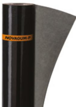
Membrana bituminosa con massa impermeabilizzante classificata BPE (Bitume Polimero Elastomero) secondo norma UNI 8818, costituita da bitume distillato modificato con elastomeri termoplastici (SBS) e da rinforzo interno composito in geotessile nontessuto di poliestere da filo continuo ad alta grammatura stabilizzato con fibre di vetro. Prodotto con marcatura CE conforme alle norme EN 13707, EN 13969, EN 13970, EN 13859-1. Flessibilità a freddo:  $\leq -25\text{ °C}$  (EN 1109).
