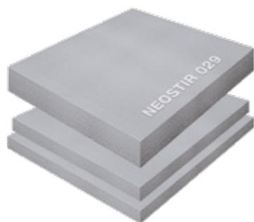
Lastre di polistirene espanso EPS stampato di color grigio additivate con grafite, con marcatura CE conformi alla Norma UNI EN 13163, con Conduttività termica  $\lambda_D = 0,029$  W/mK Norma EN 12667, con Resistenza alla compressione  $\geq 200$  kPa, conformi ai **Criteri Ambientali Minimi CAM**.
