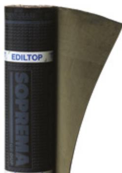
Membrana bituminosa con massa impermeabilizzante classificata BPP (Bitume Polimero Plastomero) secondo norma UNI 8818, costituita da bitume distillato modificato con polimeri poliolefinici (APP) di elevata qualità ottenuti con processo di polimerizzazione catalizzata da metalloceni e da rinforzo interno composito in geotessile nontessuto di poliestere da filo continuo stabilizzato con fibre di vetro.
