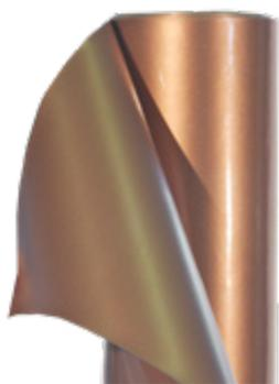
Membrana sintetica realizzata in PVC-P Copper Art per sistemi a fissaggio meccanico, armata con rete di poliestere. Prodotta per successive spalmature di compound polimerico con inglobate particelle di rame negli skin superficiali che conferiscono alla membrana le caratteristiche estetiche del metallo stesso. Resistente ai raggi UV, con marcatura CE conforme alla Norma EN 13956.
