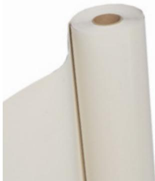
Membrana sintetica realizzata in poliolefina flessibile modificata TPO, di colorazione bianca per tutto lo spessore, con elevato indice di riflettanza solare (SRI). Ottenuta per coestrusione, stabilizzata dimensionalmente con velo di vetro, con elevata resistenza ai raggi UV.
