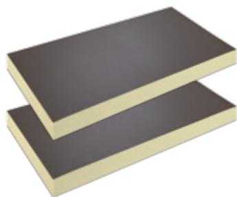
Lastre isolanti di poliuretano esenti da HCFC e HFC con marcatura CE conformi alla Norma UNI EN 13165, con rivestimento sulla faccia superiore in velovetro bitumato e su quella inferiore con velovetro mineralizzato, conformi ai **Criteri Ambientali Minimi - CAM**.
