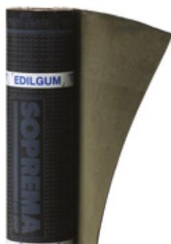
Membrana bituminosa con massa impermeabilizzante classificata BPE (Bitume Polimero Elastomero) secondo norma UNI 8818, costituita da bitume distillato modificato con elastomeri termoplastici (SBS) e da rinforzo interno composito in geotessile nontessuto di poliestere da filo continuo stabilizzato con fibre di vetro. La versione MINERAL presenta la finitura della faccia superiore autoprotetta con scaglie di ardesia ceramizzata naturale.
