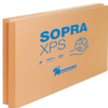
Lastre di polistirene estruso XPS, con marcatura CE conformi alla Norma UNI EN 13164, Resistenza alla compressione  $\geq 500$  kPa Norma EN 826, Reazione al fuoco in Euroclasse E, con Dichiarazione Ambientale di categoria EPD, conformi ai **Criteri Ambientali Minimi - CAM**.
