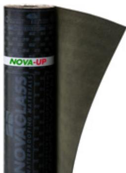
Membrana bituminosa con massa impermeabilizzante classificata BPE (Bitume Polimero Elastomero) secondo norma UNI 8818 in bitume distillato modificato con una combinazione di polimeri poliolefinici (APP) e elastomeri termoplastici (SBS). Il rinforzo interno è costituito da un'armatura in geotessile nontessuto di poliestere da filo continuo.
