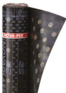
Membrana forata costituita da rinforzo interno in velo vetro con fori del diametro di 40 mm impregnato in una massa impermeabilizzante in bitume distillato modificato con polimeri poliolefinici (APP).
