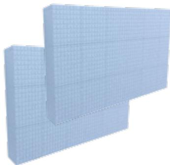
Lastre di polistirene espanso EPS stampato di color azzurro, con marcatura CE conformi alla Norma UNI EN 13163, Conduttività termica  $\lambda_D = 0,034$  W/mK Norma EN 12667, con Resistenza alla compressione  $\geq 150$  kPa, conformi ai **Criteri Ambientali Minimi - CAM**.
