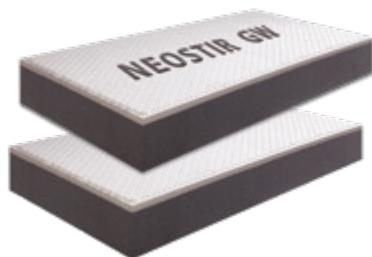
Lastre bistrato di polistirene espanso EPS stampato, con marcatura CE conformi alla Norma UNI EN 13163, costituite da uno strato di EPS stampato di color grigio additivato con grafite, con rivestimento di uno strato di EPS stampato di color bianco, Conduttività termica  $\lambda_D = 0,030$  W/mK Norma EN 12667, conformi ai **Criteri Ambientali Minimi - CAM**.
