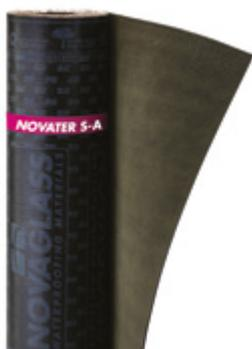
Membrana bituminosa per strato di controllo del gas Radon, con massa impermeabilizzante classificata BPP (Bitume Polimero Plastomero) secondo norma UNI 8818 costituita da bitume distillato modificato con polimeri poliolefinici (APP) di elevata qualità ottenuti con processo di polimerizzazione catalizzata da metalloceni e da rinforzo interno composito in geotessile nontessuto di poliestere da filo continuo ad alta grammatura stabilizzato con fibre di vetro.
