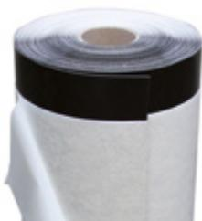
Membrana sintetica realizzata in poliolefina flessibile modificata TPO, ottenuta per costruzione, resistente ai raggi UV, stabilizzata dimensionalmente con velo di vetro ed accoppiata sulla faccia inferiore ad un geotessile non tessuto autoadesivo protetto da una pellicola rimovibile in PE siliconato. Prodotto con marcatura CE conforme alla norma EN 13956.
