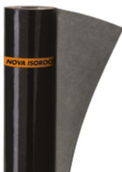
Membrana bituminosa con massa impermeabilizzante classificata BPE (Bitume Polimero Elastomero) secondo norma UNI 8818, costituita da bitume distillato modificato con elastomeri termoplastici (SBS) e da rinforzo interno composito in geotessile nontessuto di poliestere da filo continuo stabilizzato con fibre di vetro. Prodotto con marcatura CE conforme alle norme EN 13707, EN 13969, EN 13859-1. Flessibilità a freddo:  $\leq -20^{\circ}\text{C}$  (EN 1109)
