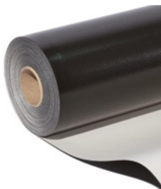
Membrana sintetica realizzata in PVC-P, ottenuta mediante costruzione, resistente ai raggi UV, armato con rete di poliestere, di colorazione bianca. Certificata per il contatto con acqua potabile. Prodotto con marcatura CE conforme alla norma EN 13956, EN 13361, EN 13362.
