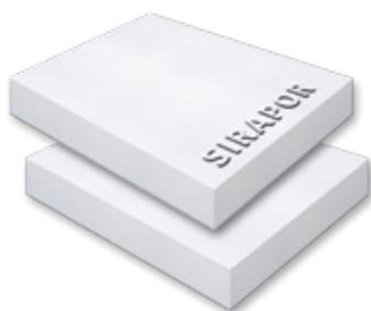
Lastre di polistirene espanso EPS, con marcatura CE conformi alla Norma UNI EN 13163, con Resistenza alla compressione  $\geq 150$  kPa, Conduttività termica  $\lambda_D = 0,034$  W/mK Norma EN 12667, con Dichiarazione Ambientale di categoria EPD, conformi ai **Criteri Ambientali Minimi - CAM**.
