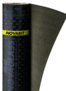
Membrana bituminosa con massa impermeabilizzante classificata BPP (Bitume Polimero Plastomero) secondo norma UNI 8818, costituita da bitume distillato modificato con polimeri poliolefinici (APP) e da rinforzo interno in velo di vetro rinforzato. Prodotto con marcatura CE conforme alle norme EN 13707, EN 13969, EN 13970.
