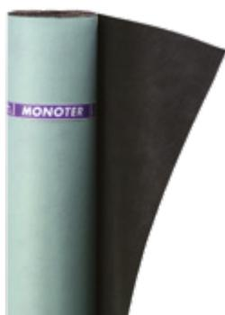
Membrana mono-bitumata con massa impermeabilizzante classificata BPP (Bitume Polimero Plastomero) secondo norma UNI 8818 costituita da geotessile nontessuto di poliestere da filo continuo di elevata grammatura, accoppiato solo sulla faccia inferiore con massa impermeabilizzante in bitume distillato modificato con polimeri poliolefinici (APP).
