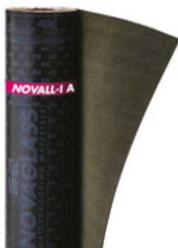
Membrana bituminosa per strato di controllo del gas Radon e del vapore, con massa impermeabilizzante classificata BPE (Bitume Polimero Elastomero) secondo norma UNI 8818 in bitume distillato modificato con elastomeri termoplastici (SBS). Il rinforzo interno è costituito da un'armatura in velo di vetro rinforzato accoppiato ad una lamina di Alluminio che rende la membrana assolutamente impermeabile al passaggio del vapore acqueo e del gas Radon.
