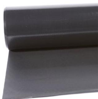
Membrana sintetica in poliolefina flessibile modificata TPO, ottenuta per coestrusione, dotata di signal layer, stabilizzata dimensionalmente con velo di vetro, resistente ai raggi UV. Certificata per il contatto con acqua potabile\*\*. Prodotto con marcatura CE conforme alla norma EN 13361, EN 13362.
