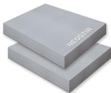
Lastre di polistirene espanso EPS di color grigio additivate con grafite, con marcatura CE conformi alla Norma UNI EN 13163, con Conduttività termica  $\lambda_D = 0,030$  W/mK Norma EN 12667, con Dichiarazione ambientale EPD di categoria, conformi ai **Criteri Ambientali Minimi - CAM**.
