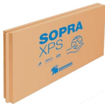
Lastre di polistirene estruso XPS, con marcatura CE conformi alla Norma UNI EN 13164, Resistenza alla compressione  $\geq 250$  kPa Norma EN 826, Reazione al fuoco in Euroclasse E, con Dichiarazione Ambientale di categoria EPD, conformi ai **Criteri Ambientali Minimi - CAM**.
