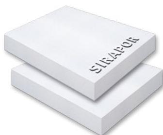
Lastre di polistirene espanso EPS, con marcatura CE conformi alla Norma UNI EN 13163, Conduttività termica  $\lambda_D = 0,036$  W/mK Norma EN 12667, con Dichiarazione Ambientale di categoria EPD, conformi ai **Criteri Ambientali Minimi - CAM**.
