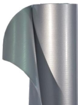
Membrana sintetica Silver Art realizzata in PVC-P per sistemi a fissaggio meccanico, armata con rete di poliestere e dotata di laccatura superficiale. Prodotta per successive spalmature di compound polimerico con inglobate particelle di alluminio negli skin superficiali che determinano la speciale finitura a vista simile a una lamina di alluminio flessibile. Resistente ai raggi UV, con marcatura CE conforme alla Norma EN 13956.
