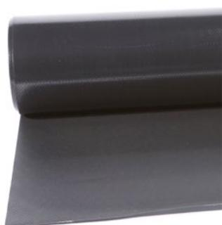
Membrana sintetica in PVC-P omogenea, ottenuta mediante coestrusione, con elevata resistenza ai microorganismi e resistente ai raggi UV. Prodotto con marcatura CE conforme alla norma EN 13361, EN 13492\*.
