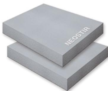
Lastre di polistirene espanso EPS di color grigio additivate con grafite, con marcatura CE conformi alla Norma UNI EN 13163, con Conduttività termica  $\lambda_D = 0,030$  W/mK Norma EN 12667, con Resistenza alla compressione  $\geq 150$  kPa, con Dichiarazione Ambientale EPD di categoria, conformi ai **Criteri Ambientali Minimi - CAM**.
