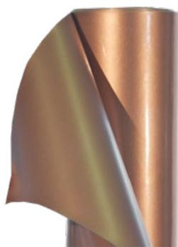
Membrana sintetica realizzata in PVC-P Copper Art per sistemi a fissaggio meccanico, armata con rete di poliestere. Prodotta per successive spalmature di compound polimerico con inglobate particelle di rame negli skin superficiali che conferiscono alla membrana le caratteristiche estetiche del metallo stesso. Resistente ai raggi UV, con marcatura CE conforme alla Norma EN 13956.
