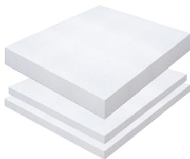
Lastre di polistirene espanso EPS stampato, con marcatura CE conformi alla Norma UNI EN 13163, con Conduttività termica  $\lambda_D = 0,033$  W/mK Norma EN 12667, Resistenza alla compressione  $\geq 200$  kPa Norma EN 826.
