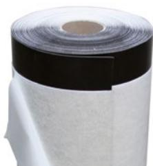
Membrana sintetica realizzata in poliolefina flessibile modificata TPO, dotata di signal layer, ottenuta per coestrusione, resistente ai raggi UV, stabilizzata dimensionalmente con velo di vetro ed accoppiata sulla faccia inferiore ad un geotessile non tessuto autoadesivo protetto da una pellicola rimovibile in PE siliconato.
