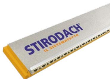
Lastra termoisolante di polistirene espanso estruso XPS con rivestimento all'estradosso di una membrana in alluminio gofrato basso-emissivo con profilo metallico portategola, conforme ai **Criteri Ambientali Minimi - CAM**.
