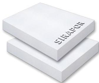
Lastre di polistirene espanso EPS, con marcatura CE conformi alla Norma UNI EN 13163, con Resistenza alla compressione  $\geq 200$  kPa, Conduttività termica  $\lambda_D = 0,033$  W/mK Norma EN 12667, con Dichiarazione Ambientale di categoria EPD, conformi ai **Criteri Ambientali Minimi - CAM**.
