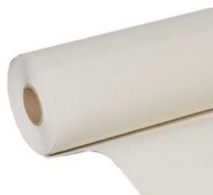
Membrana sintetica realizzata in PVC-P, di colore bianco per tutto lo spessore, con elevato indice di riflettanza solare (SRI). Prodotta per coostrusione (Flagon SR) o spalmatura (Flagon SR e Flagon SRF), armata con rete di poliestere, con elevata resistenza ai raggi UV.
