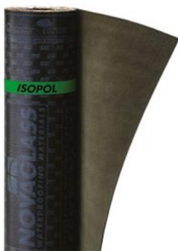
Membrana bituminosa con massa impermeabilizzante classificata BPP (Bitume Polimero Plastomero) secondo norma UNI 8818, costituita da bitume distillato modificato con polimeri poliolefinici (APP) di elevata qualità ottenuti con processo di polimerizzazione catalizzata da metalloceni e da rinforzo interno composito in geotessile nontessuto di poliestere da filo continuo stabilizzato con fibre di vetro. Prodotto con marcatura CE conforme alle norme EN 13707, EN 13969, EN 13970, EN 13859-1
