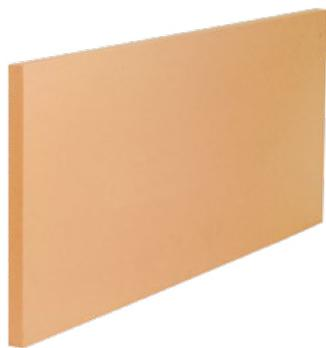
Lastre di polistirene estruso XPS con superficie ruvida, con marcatura CE conformi alla Norma UNI EN 13164, con conduttività termica  $\lambda_D = 0,033$  W/mK Norma EN 12667, Resistenza alla compressione  $\geq 250$  kPa Norma EN 826, Reazione al fuoco in Euroclasse E, con Dichiarazione Ambientale di categoria EPD, conformi ai **Criteri Ambientali Minimi - CAM**.
