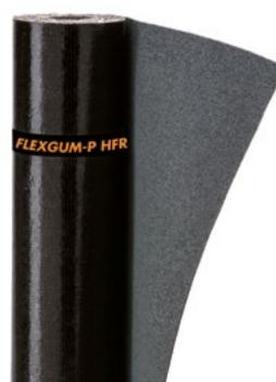
Membrana bituminosa con massa impermeabilizzante classificata BPE (Bitume Polimero Elastomero) secondo norma UNI 8818, in bitume distillato modificato con elastomeri termoplastici (SBS). Il rinforzo interno è costituito da una **tripla armatura composita** in geotessile nontessuto di poliestere da filo continuo ad alta grammatura stabilizzato con fibre di vetro. Presenta la finitura della faccia superiore autoprotetta con scaglie di ardesia ceramizzata naturale o colorata.
