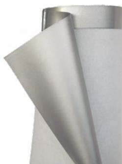
Membrana sintetica Silver Art realizzata in PVC-P per sistemi a fissaggio meccanico, armata con rete di poliestere, dotata di laccatura superficiale ed accoppiata sulla faccia inferiore con un geotessile non tessuto di poliestere. Prodotta per successive spalmature di compound polimerico con inglobate particelle di alluminio negli skin superficiali che determinano la speciale finitura a vista, stabile nel tempo. Resistente ai raggi UV, con marcatura CE conforme alla Norma EN 13956.
