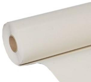
Membrana sintetica realizzata in PVC-P, di colore bianco per tutto lo spessore, con elevato indice di riflettanza solare (SRI). Armata con rete di poliestere, prodotta per coestrusione o per spalmatura, resistente ai raggi UV.
