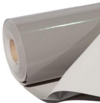
Membrana sintetica realizzata in PVC-P, prodotta per coostrusione o spalmatura, dotata di signal layer, stabilizzata dimensionalmente con velo di vetro, resistente ai raggi UV. Prodotto con marcatura CE conforme alla Norma EN 13956 ed EN 13967.
