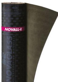
Membrana bituminosa per strato di controllo del vapore, con massa impermeabilizzante classificata BPE (Bitume Polimero Elastomero) secondo norma UNI 8818 in bitume distillato modificato con elastomeri termoplastici (SBS). Il rinforzo interno è costituito da un'armatura in velo di vetro rinforzato accoppiato ad una lamina di Alluminio che rende la membrana assolutamente impermeabile al passaggio del vapore acqueo.
