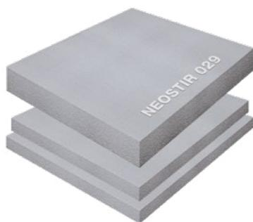
Lastre di polistirene espanso EPS stampato di color grigio additate con grafite, con marcatura CE conformi alla Norma UNI EN 13163, con Conduttività termica  $\lambda_D = 0,029$  W/mK Norma EN 12667, con Resistenza alla compressione  $\geq 200$  kPa, conformi ai **Criteri Ambientali Minimi CAM**.
