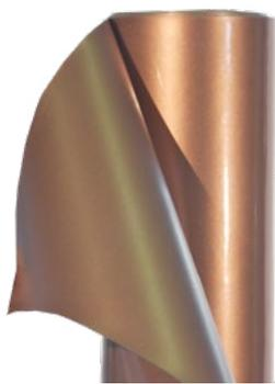
Membrana sintetica realizzata in PVC-P per finiture Copper Art, stabilizzata dimensionalmente con velo di vetro. Prodotta per successive spalmature di compound polimerico con inglobate particelle di rame negli skin superficiali che conferiscono alla membrana le caratteristiche estetiche del metallo stesso. Resistente ai raggi UV, con marcatura CE conforme alla Norma EN 13956.
