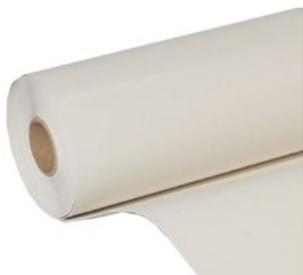
Membrana sintetica realizzata in poliolefina flessibile modificata TPO, di colore bianco per tutto lo spessore, con elevato indice di riflettanza solare (SRI). Ottenuta per coestrusione, armata con rete di poliestere, con elevata resistenza ai raggi UV.
