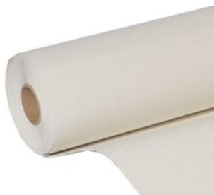
Membrana sintetica realizzata in poliolefina flessibile modificata TPO, di colore bianco per tutto lo spessore, con elevato indice di riflettanza solare (SRI). Ottenuta per coestrusione, resistente ai raggi UV, armata con rete di poliestere. Prodotti con marcatura CE conforme alla norma EN 13956.
