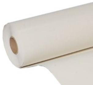
Membrana sintetica realizzata in poliolefina flessibile modificata TPO, di colore bianco per tutto lo spessore, con elevato indice di riflettanza solare (SRI). Ottenuta per coestrusione, stabilizzata dimensionalmente con velo di vetro, con elevata resistenza ai raggi UV.
