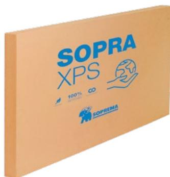
Lastre di polistirene estruso XPS, con marcatura CE conformi alla Norma UNI EN 13164, Resistenza alla compressione  $\geq 300$  kPa Norma EN 826, Reazione al fuoco in Euroclasse E, con Dichiarazione Ambientale di categoria EPD, conformi ai **Criteri Ambientali Minimi - CAM**.
