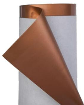
Membrana sintetica realizzata in PVC-P Copper Art per sistemi a totale aderenza, stabilizzata dimensionalmente con velo di vetro ed accoppiata sulla faccia inferiore con un geotessile non tessuto. Prodotta per successive spalmature di compound polimerico con inglobate particelle di rame negli skin superficiali che conferiscono alla membrana le caratteristiche estetiche del metallo stesso. Resistente ai raggi UV, con marcatura CE conforme alla Norma EN 13956.
