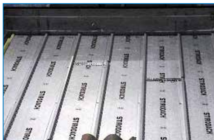
Prova di resistenza al carico discendente - Rel. Tecnica nr. 4367/RT/07 Vista estradosso del campione prima della posa delle tegole
