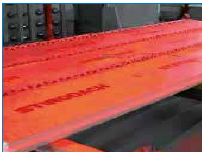
Prova di invecchiamento accelerato - Rel. Tecnica nr. 4263/RT/06 Campione in assetto sperimentale durante la fase di irraggiamento a 60°C
