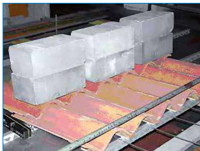
Prova di resistenza del profilo metallico portategole - Rel. Tecnica nr. 4290/RT/06 - Fase di carico di schiacciamento e trazione dei profili metallici
